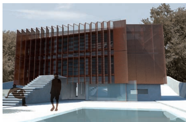
Plemmirio, restyling totale di un'abitazione per vacanze degli anni '60 sulla costa siracusana. Nello schema, il sistema di vele verticali, dimensionate e orientate per raccogliere le brezze marine in estate, garantisce il raffrescamento passivo, mentre le lamelle orizzontali, posizionate parametricamente, seguono il percorso solare e schermano durante le ore più calde.
